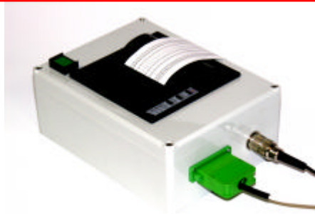
Seitliche Anschlüsse für die Sensoren und die Spannungsversorgung
