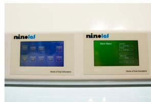
Separate Displays für Steuerung und Status-/Alarmmeldungen
